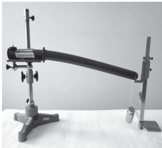
Рис. 3. Стенд для контролювання пружності та еластичності гумових кийків
