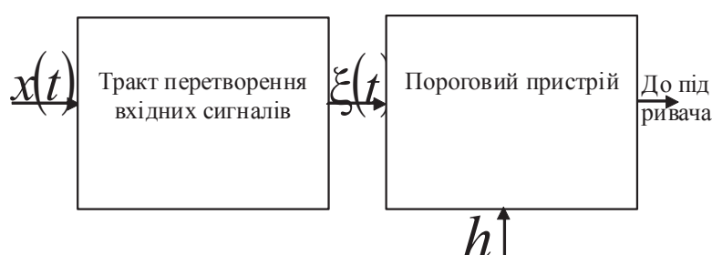
Рис. 2. Радіоприймач вибухового пристрою
