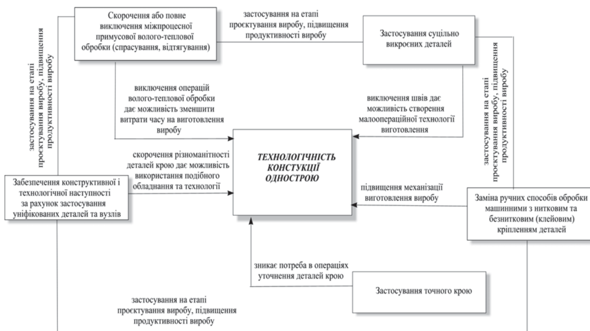
Рис. 5. Схема основних принципів проектування для підвищення ступеня технологічності конструкцій предметів (комплектів) однострою
