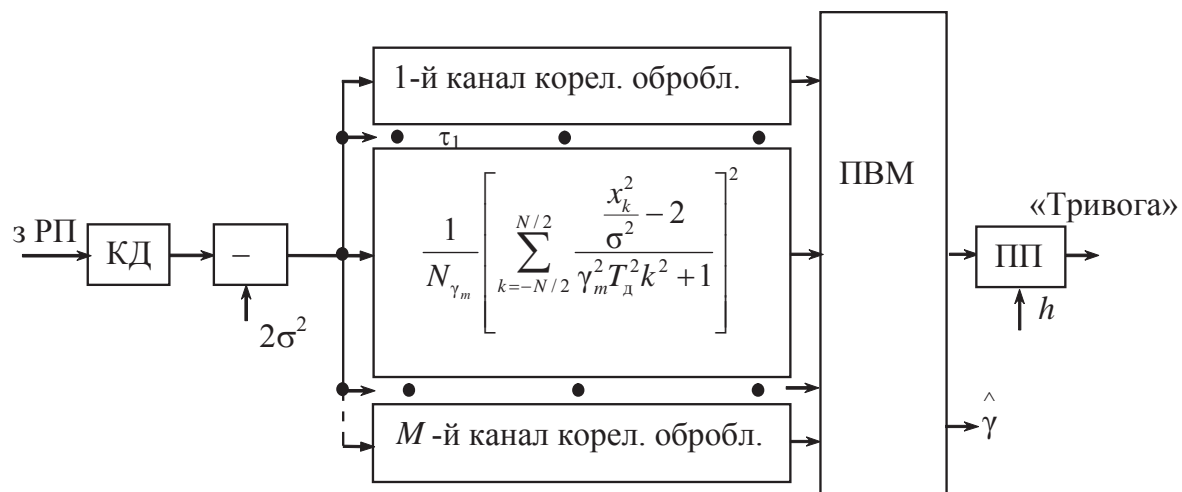
Рис. 3. Пристрій оброблення обгинаючої сигналу
