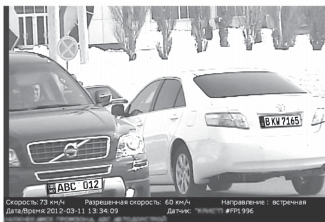
Рис. 2. Неправильне встановлення (налаштування) пересувного комплексу фотовідеофіксації порушень ПДР (кілька цілей в кадрі)
