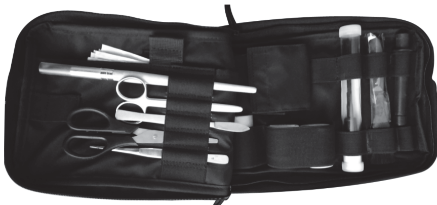
Рис. 3. ТКЗ для вилучення слідів, які розміщені у внутрішньому просторі підсумка для дактилоскопічного набору та інших засобів пошуку та фіксації слідів
